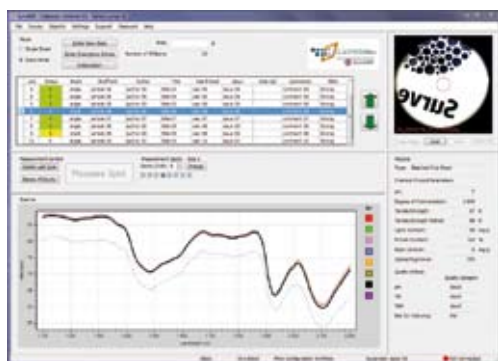
Hauptfenster der SurveNIR Software mit übersichtlicher Darstellung der Probedaten, NIR-Spektren, Videofunktion zur Probenpositionierung sowie der Messergebnisse
