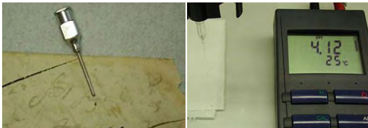
Abbildung 5. Probennahme mit Hohlneedle und Messung des pH-Wertes mit kombinierter Mikro-pH-Elektrode.
